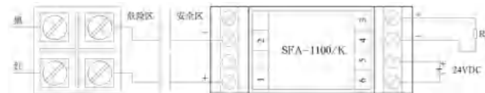
流量计与隔离式安全栅接线图
