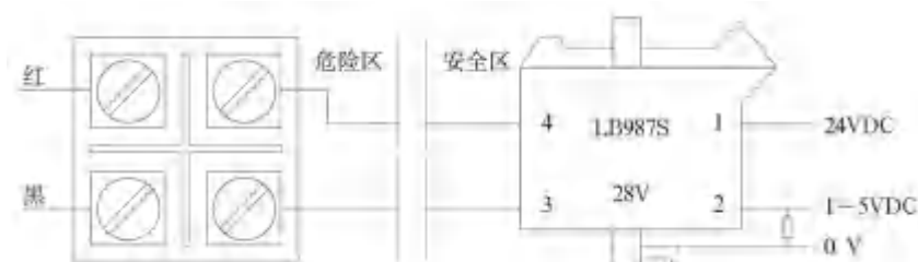
流量计与齐纳式安全栅接线图
